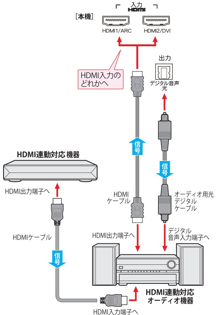
※ ARC対応のオーディオ機器を、ARC対応のHDMIケーブルでHDMI入力1 (ARC) 端子に接続する場合は、デジタル音声ケーブルの接続は不要です。
