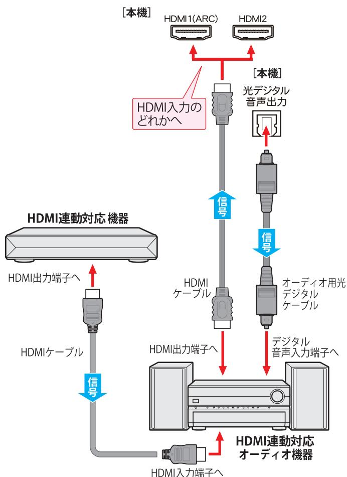
※ ARC対応のオーディオ機器を、ARC対応のHDMIケーブルでHDMI入力1 (ARC) 端子に接続する場合は、デジタル音声ケーブルの接続は不要です。
